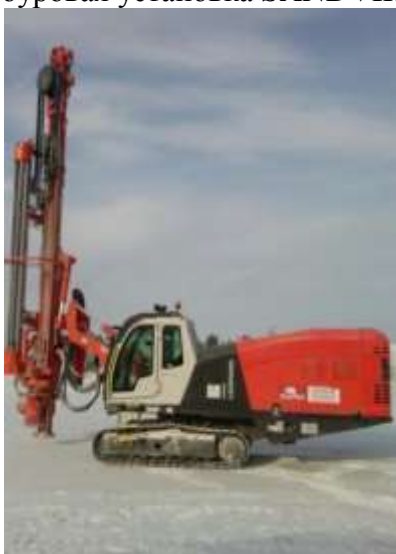
Рис. 44 Буровая установка DI550 “Leopard”, Финляндия, год приобретения 2016.
