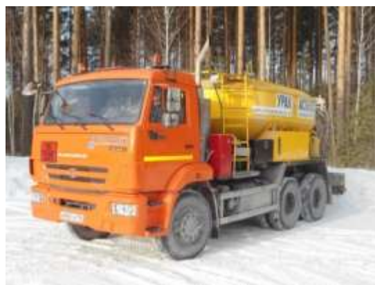
Рис. 39 Смесительно-зарядные машины СЗГМ-15Э и СЗГМ-8 (год ввода – 2015)
