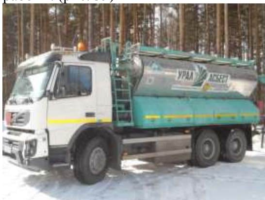
Рис. 39 Смесительно-зарядные машины СЗГМ-15Э и СЗГМ-8 (год ввода – 2015)
