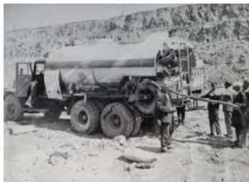
Рис. 14 Зарядная машина МЗВ-3. Зарядание игданитом (расплавленная АС с гранулолом), 1976 год
